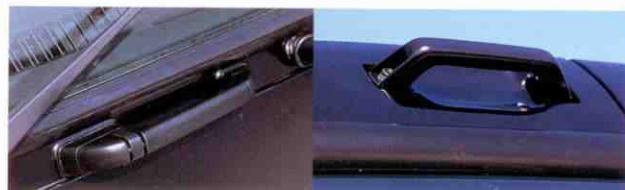
Ручки, имеющиеся в верхней и нижней частях ветрового стекла, служат устойчивой опорой для обычной очистки
