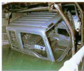
Процесс антикоррозийной обработки полным погружением
