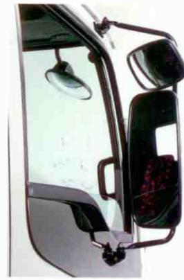
Участок обзора, закрытый от водителя, устранен и задняя обзорность улучшена благодаря трехточечным зеркалам
