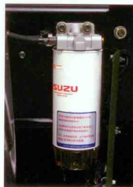
Крупногабаритный отстойник удаляет осадок и водяной отстой из поддона картера
