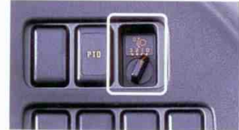
Выключатель корректировки направления пучка света фар позволяет направлять фары вверх или вниз в зависимости от нагрузки для расширения обзорности
